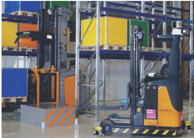
Un chariot autonome FM14i à guidage laser dialoguant avec un préparateur de commandes MX-X
